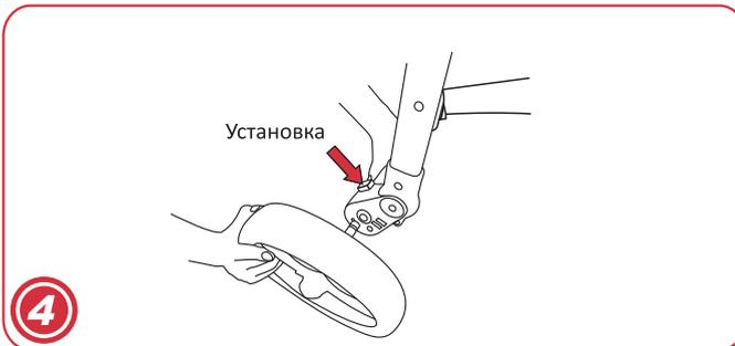
**4 Установка задних колес:**
