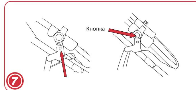
**7 Установка и снятие универсального блока коляски:**
