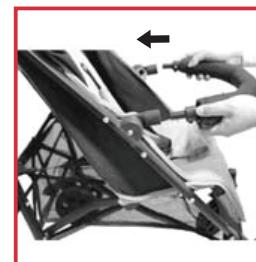
Щоб прикріпити бампер до каркасу, вставте два пластмасових кінця бампера у відповідні опори. Щоб зняти захисний бампер, натисніть на дві кнопки, які розташовані збоку на самому бампері і потягніть бампер до себе.
